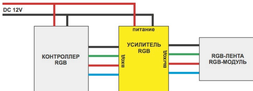
Рис. Усиление слабого RGB-выхода контроллера
