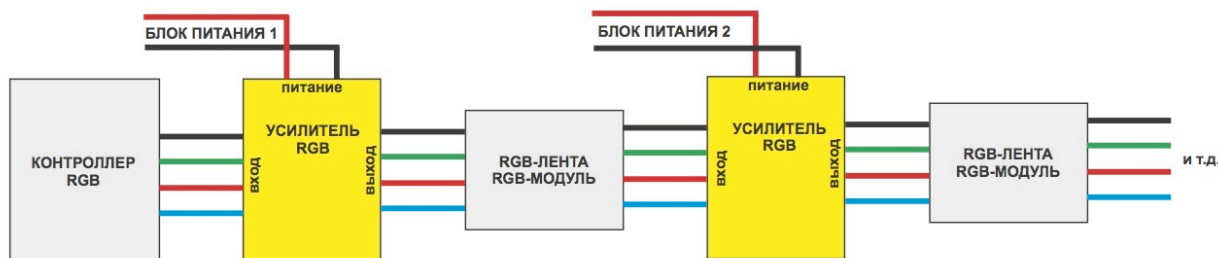
Рис. Усиление сигнала и питание каждого усилителя от своего источника
