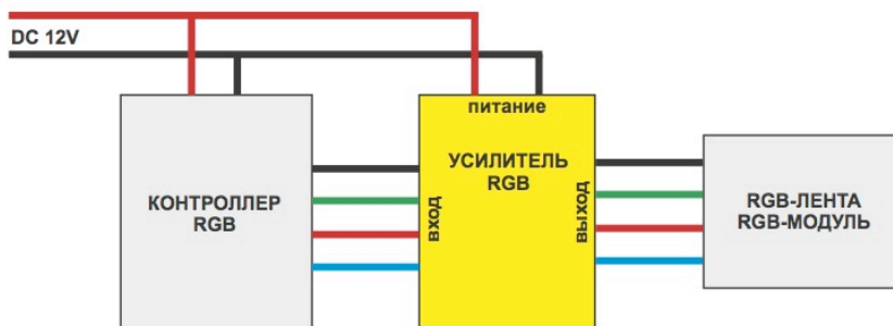
Рис. Усиление слабого RGB-выхода контроллера
